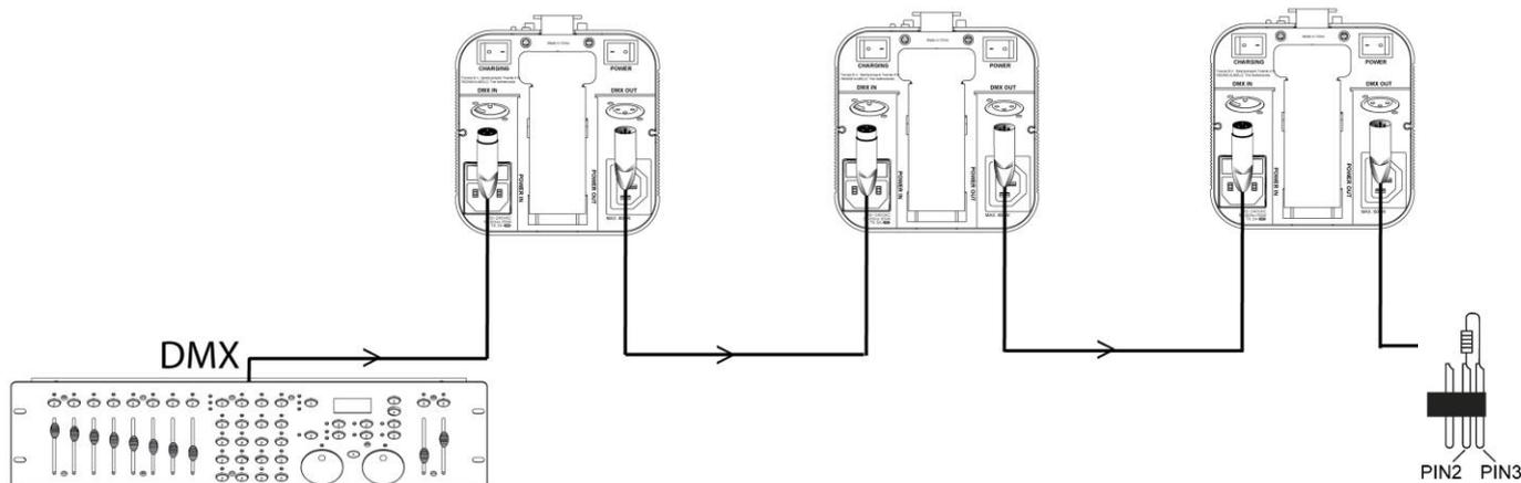
Na końcu ostatniego urządzenia należy wpiąć terminator DMX. Jest to niewielkie urządzenie wyglądające jak wtyk XLR, w którym piny 2 oraz 3 są połączone ze sobą oraz opornikiem 120 Ohm.
