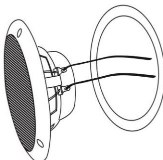
3. Stecken Sie den Lautsprecher in das Loch und schrauben Sie jede der Schrauben fest.
