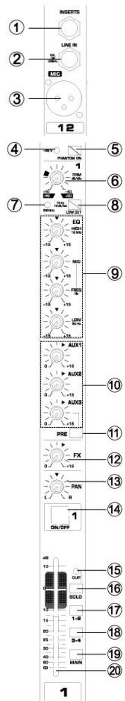
De Pan-regelaar bepaalt de stereopositie van het kanaalsignaal. Bij het werken met subgroepen, kunt u de Pan-regelaar gebruiken om het signaal toe te wijzen aan één uitgang, die u extra flexibiliteit in opnamesituaties geeft.
