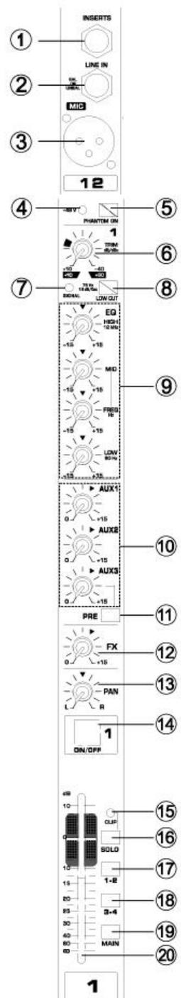
Der Pan-Regler bestimmt die Stereoposition des Kanalsignals. Wenn mit Untergruppen arbeiten, können Sie die Pan-Regler verwenden, um das Signal zu einem Ausgang zu weisen, die Sie zusätzliche Flexibilität in Aufnahmesituationen gibt.
