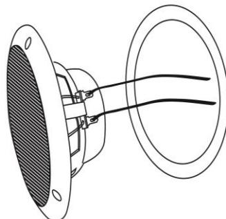
3. Stecken Sie den Lautsprecher in das Loch und schrauben Sie jede der Schrauben fest.
